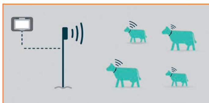
Abbildung 1: Schematische Darstellung der einzelnen Komponenten des Aktivitätsmesssystems
