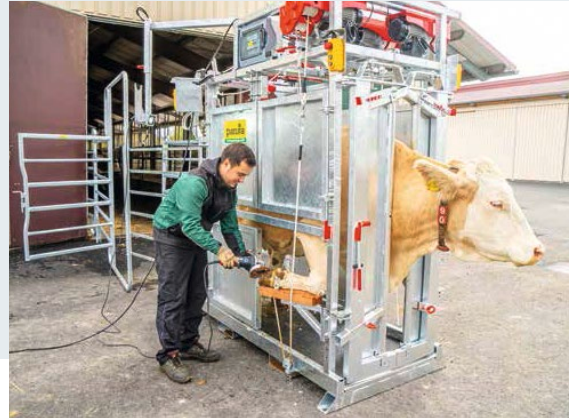
Der Klauenpflegeständer muss auf einem ebenen Boden stehen. (Foto: Patura)
