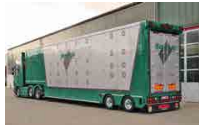
Tiertransport auf höchstem Standard: Das Fahrzeug ist mit Querlüftung vollklimatisiert und verfügt über Tränkenippel für jedes einzelne Kalb.
