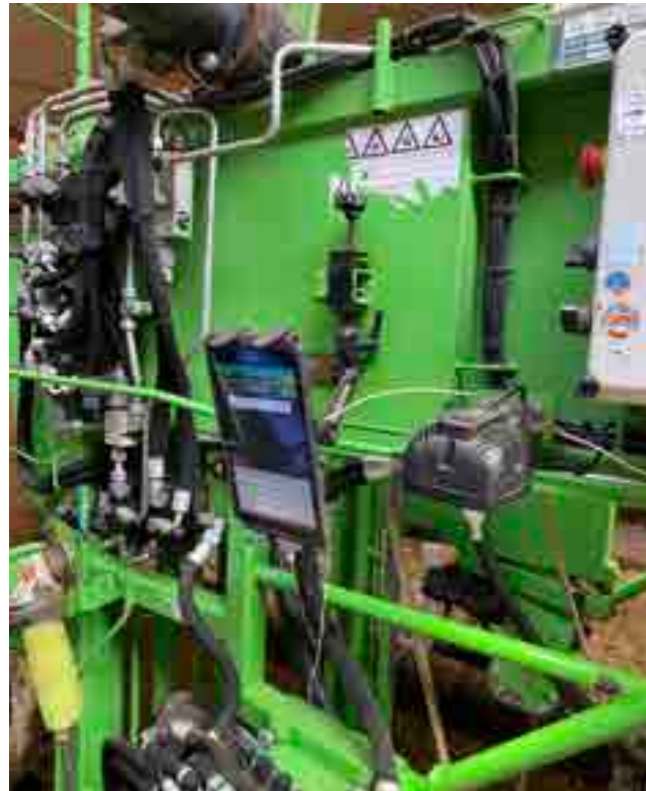
Das Tablet zur Erfassung der Klauenbefunde ist so befestigt, damit es bei der Klauenpflege nicht stört.
