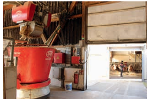
Lely Vector in der Futterküche bei der Beladung und Sicht auf den Fahrweg zum Milchviehstall
